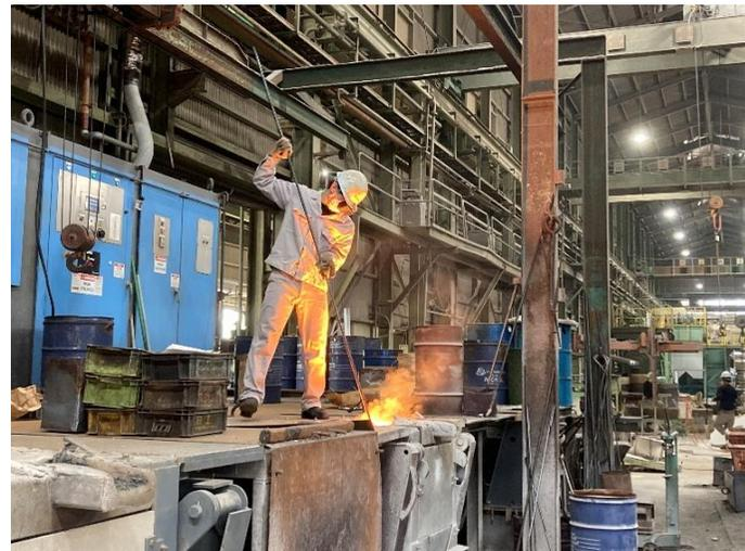
材料を溶解炉で溶かします。不純物を取り除きながら、規定の温度まで上昇させます。
