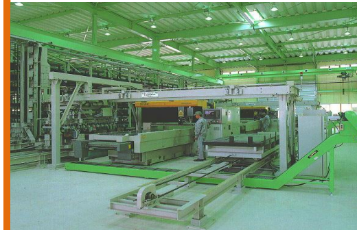
レーザー切断加工
